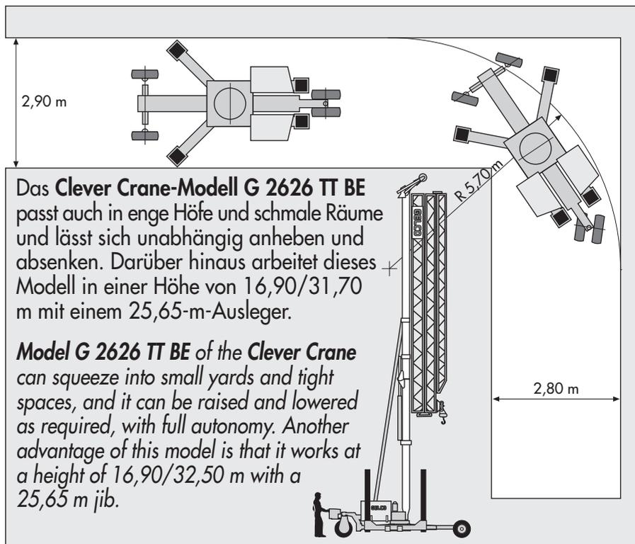
Das **Clever Crane-Modell G 2626 TT BE** passt auch in enge Höfe und schmale Räume und lässt sich unabhängig anheben und absenken. Darüber hinaus arbeitet dieses Modell in einer Höhe von 16,90/31,70 m mit einem 25,65-m-Ausleger.
